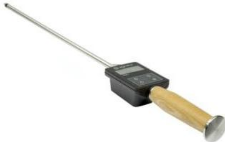
Sl. 14 Primer uređaja za brzo utvrđivanje sadržaja vlage u balama biomase
