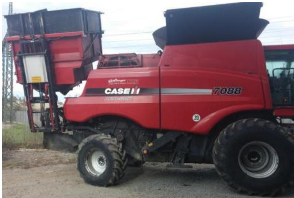
Sl. 18 Patentirano rešenje za ubiranje oklasak (bez komušine) tokom berbe zrna
