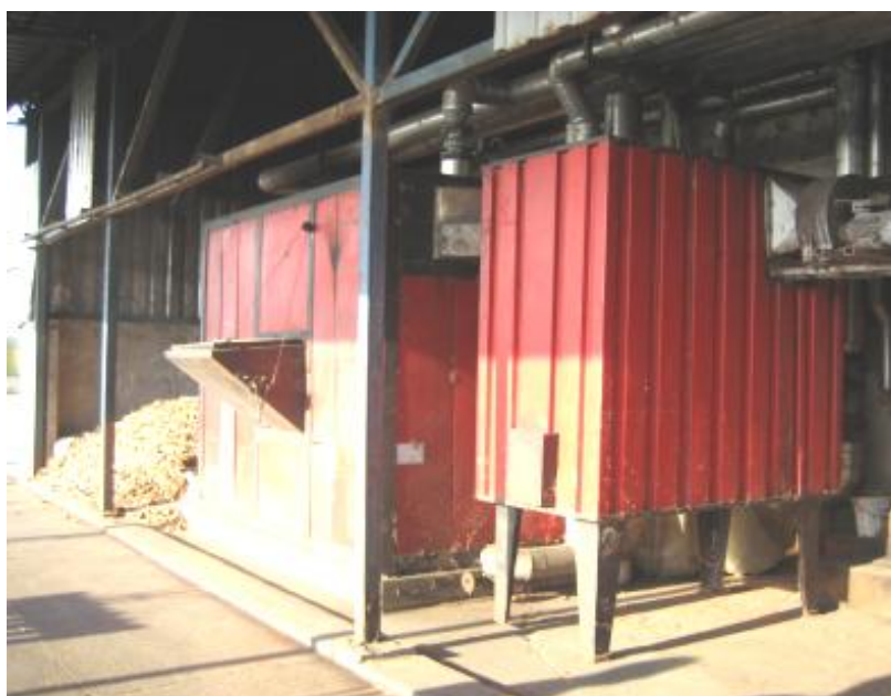
Sl. 7 Primer generatora toplog vazduha za sušenje klipa semenskog kukuruza, koji kao gorivo koristi oklasak
