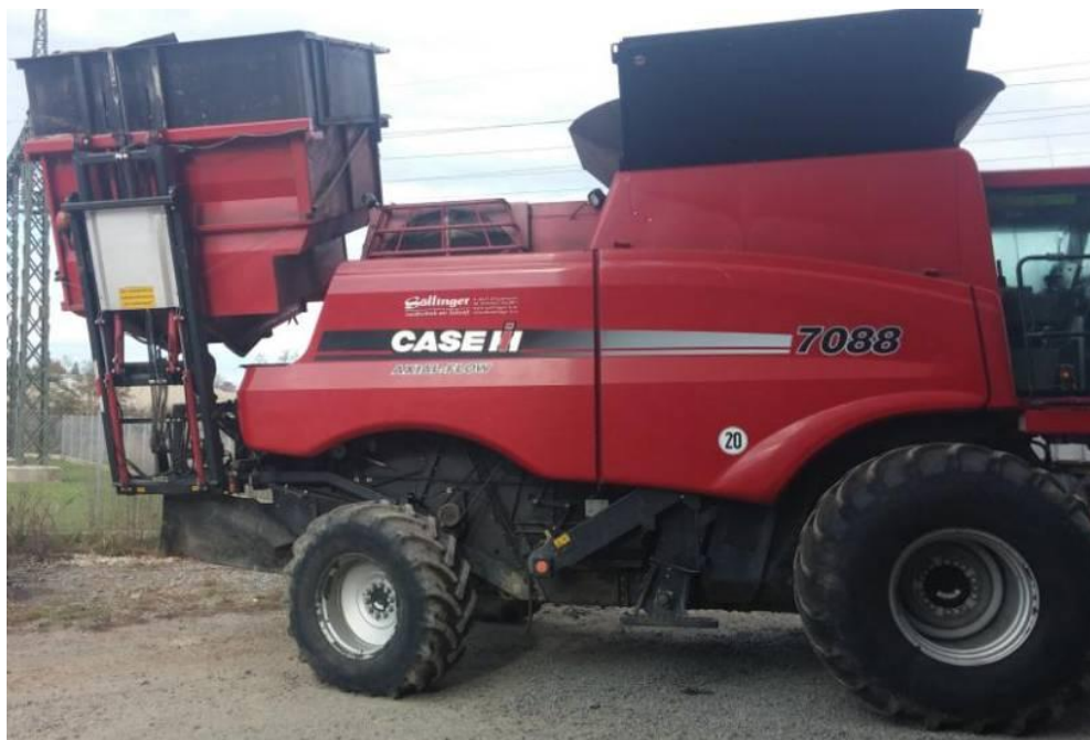
Sl. 23 Patentirano rešenje za sakupljanje oklasaka (bez komušine) tokom berbe zrna
