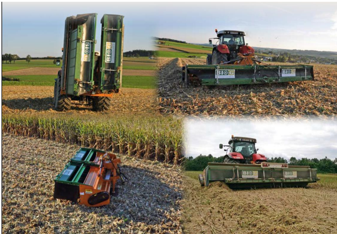
Sl. 25 Sitnilica kukuruzovine koja formira bočni zboj Biochipper
