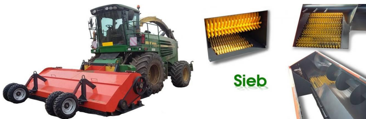
Sl. 26 Uređaj Strohmax 5000 , koji se koristi kao heder silažnog kombajna
