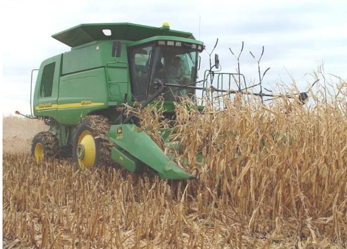
Sl. 20 Sakupljanje kukuruzovine sa odsecanjem stabljike na visini, High Cut , levo, uspravna stabljika koja preostaje na parceli, desno
