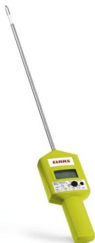
Sl. 45 Claas -ov merač sadržaja vlage u balama
