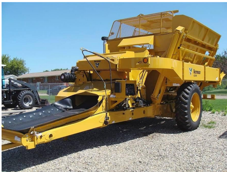
Sl. 22 Prikolica za prihvatanja oklasaka i komušine sa visokim pretovarom
