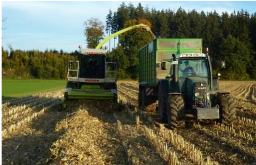
Sl. 24 Sakupljanje kukuruzovine iz zboja i seckanje silažnim kombajnom
