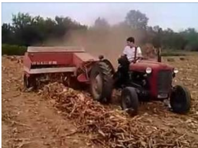
Sl. 17 Presovanje kukuruzovine u formi konvencionalnih četvrtastih bala
