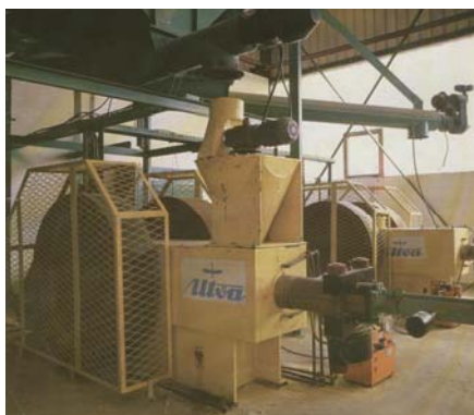
Sl. 8.2. Mehanička stacionarna briket presa proizvodnje fabrike „Utva” iz Pančeva (koš, dozator, alat prese, radni cilindar sa klipom, zamajni točkovi, elektromotor)
