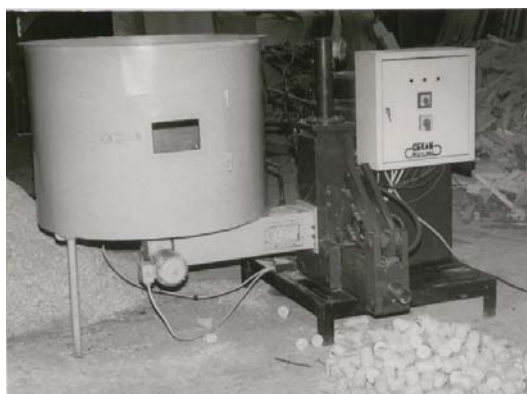
Sl. P7: Izgled prese za briketiranje firme „Dekan” iz Vrnjačke Banje sa jednostepenom hidrauličnom pumpom
