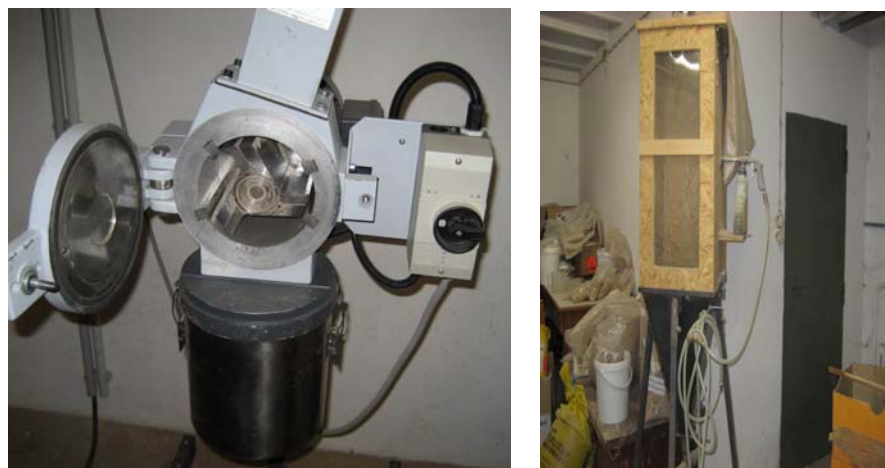
Sl. P1 Sečka za usitnjavanje biomaterijala za proizvodnju peleta, levo, eksperiment sa vezivnim sredstvima za proizvodnju peleta, desno
