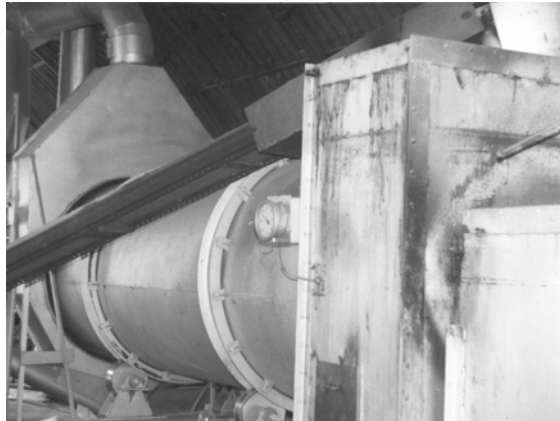
Sl. 10.12. Linija za sušenje vlažnog drvnog otpatka od topole
