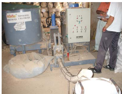
Sl. P8: Presa za briketiranje u firmi „Ogrev”, Ruski Krstur sa dvostepenom hidrauličnom pumpom
