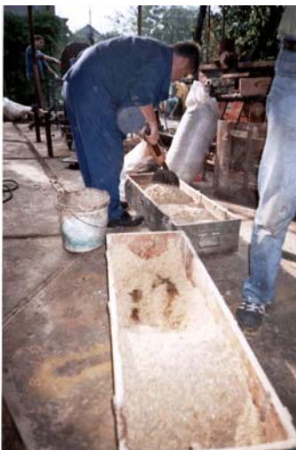
Sl. P5: Priprema mešavine slame za peletiranje - kvašenje vodom i ručno mešanje
