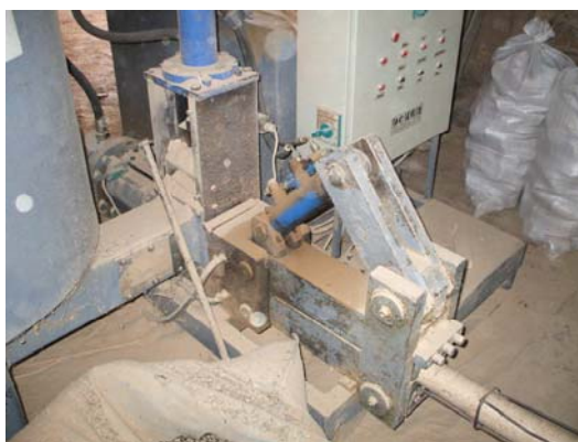
Sl. P8: Presa za briketiranje u firmi „Ogrev”, Ruski Krstur sa dvostepenom hidrauličnom pumpom
