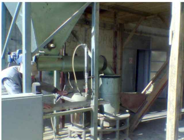
Sl. 9.2. Prikaz pogona za peletiranje firme „Fasada” u Crvenki (usipni koš za usitnjenu biomasu, mešalica u košu, puž dozator, kondicioner mase, presa sa elektromotornim pogonom, kosi elevator)
