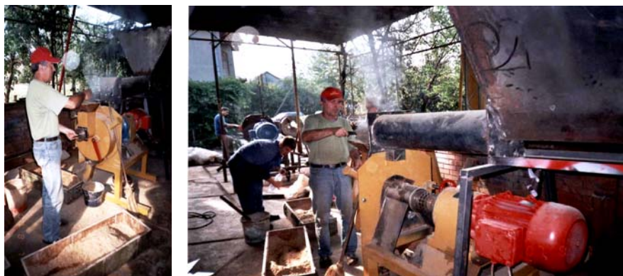
Sl. P3 : Eksperimentalno postrojenje za peletiranje biomase: a) pogled s prednje strane i b) pogled sa zadnje strane
