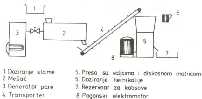
Sl. 11.3: Eksperimentalna instalacija sa presom sa valjcima i diskosnom matricom
