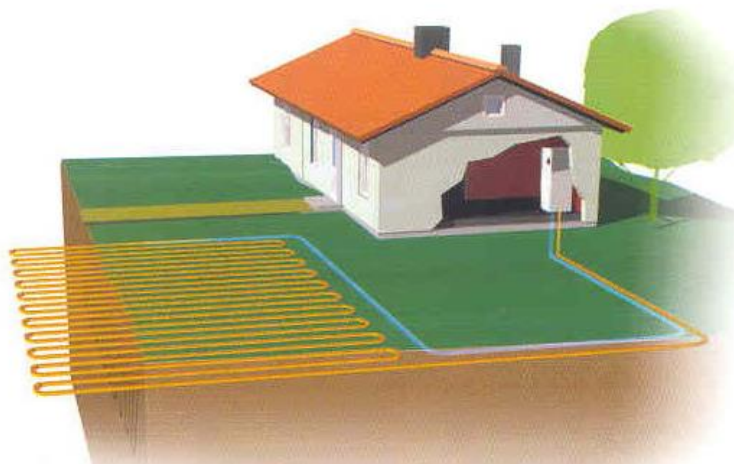
Sl.5.4. Sistem za dobijanje toplote iz zemlje – horizontalni registri
