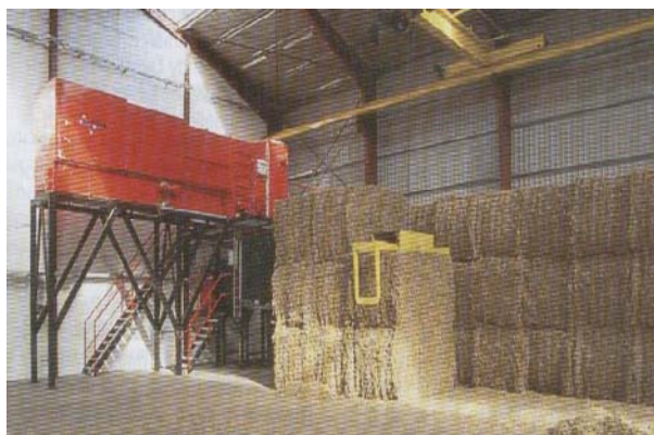
Slika 11: Transport velikih prizmatičnih bala kranom u natkrivenom skladištu
