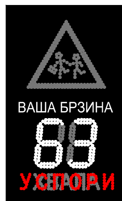
Režim rada VI Vozilo se kreće brzinom preko 50 km/h - prikazuje se brzina i natpis "УСПОРИ" blinka
