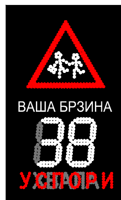
Režim rada III Vozilo se kreće brzinom 30-50 km/h
