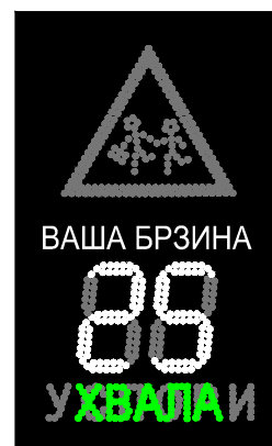
Režim rada II Vozilo se kreće brzinom 20-30 km/h
