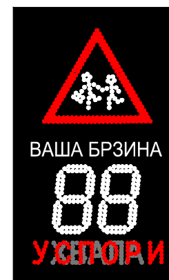
Režim rada IV Vozilo se kreće brzinom preko 50 km/h - simbol i tekst "УСПОРИ" blinkaju
