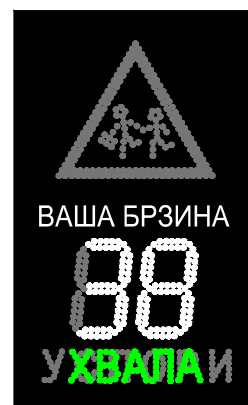
Režim rada V Vozilo se kreće brzinom 20-50 km/h
